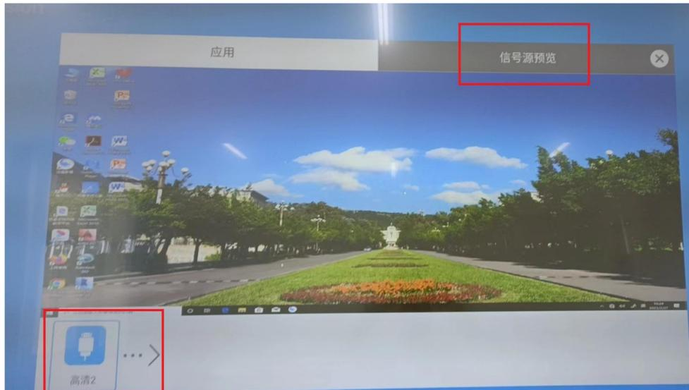
如果出现电脑显示器开而大屏待机情况，则关闭教室门口电源断电约 1 分钟后再开电源，重复上面步骤。
