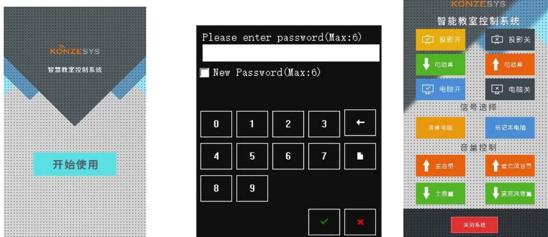
2. 系统开启后也可根据上课需要选择相应的操作。比如投影机开关（若控制面板投影开关不可用，则可用投影机遥控器），电脑开关，主音量（电脑音量）的加减或者信号源的切换等。讲桌侧面有外接设备的接口。比如 U 盘接口，电源接口，网络接口，笔记本信号输入接口等。
